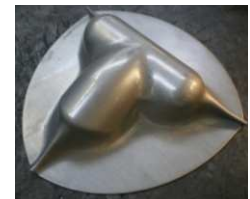
Pièce réalisée en emboutissage hydroform (Titane 1,8 mm)
